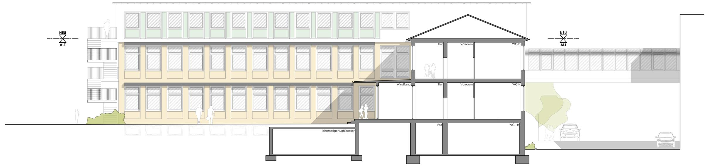
Ostansicht Bauteil B mit Teilschnitt
